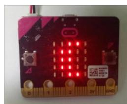
Teste le programme ci-dessous qui affiche une image **de lune** si on baisse la luminosité (en recouvrant la carte avec sa main par exemple) et **un soleil** sinon.
