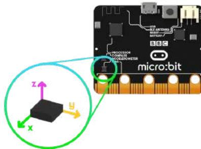
Un accéléromètre mesure l'accélération de la carte micro:bit, ce composant détecte quand la micro:bit est en mouvement. Il peut aussi détecter d'autres actions (gestes), par exemple quand elle est secouée, inclinée ou qu'elle tombe.
